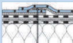
**NOVOPROOF® DA-S** mit mechanischer Befestigung
